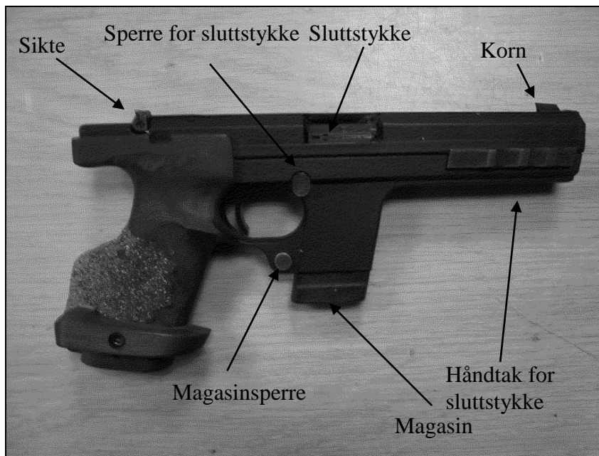
Automatpistol Hämmerli 280 kaliber .22 lr. En lett pistol grunnet bruk av plastmateriale.
